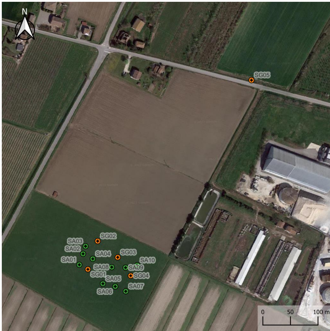
Figura 4.2-1 ubicazione indagini di caratterizzazione in corrispondenza dell'area della futura sottostazione elettrica (sondaggi ambientali punti verdi e sondaggi ambientali/geognostici punti arancioni)
