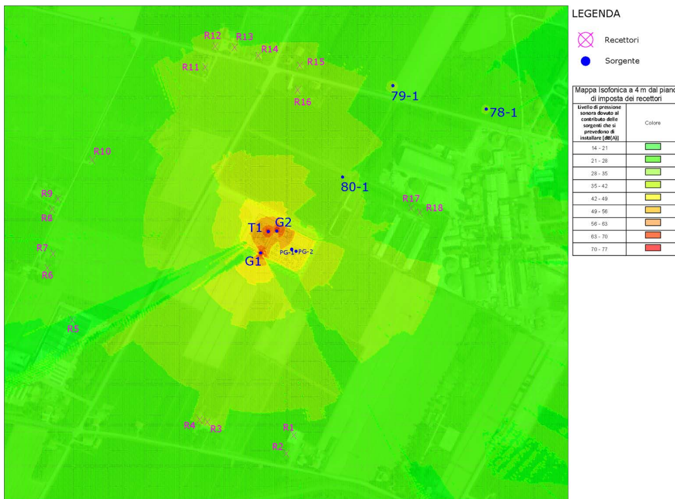
Figura 6.4.2-2 – Mapa isofonica delle emissioni prodotte in fase di esercizio dalle nuove sorgenti relative alle opere accessorie nello scenario di emergenza (con gruppi elettrogeni attivi), nel periodo diurno o notturno, alla quota di 4 m dal piano campagna
