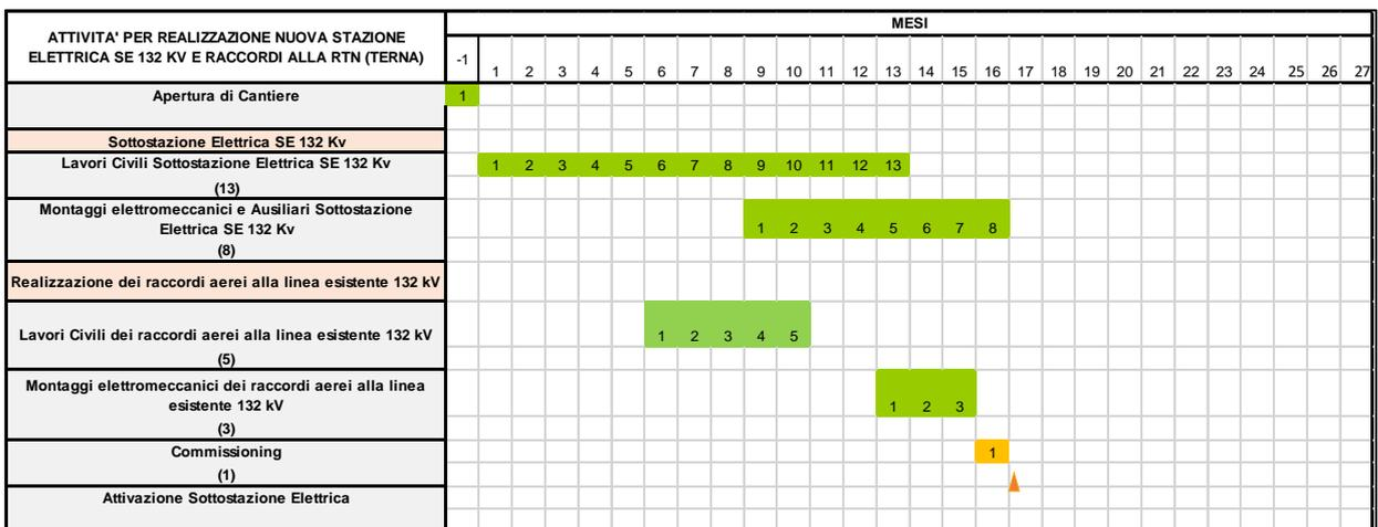
Figura 3.5-3 Programma di realizzazione delle Opere di Connessione alla rete elettrica nazionale (RTN)
