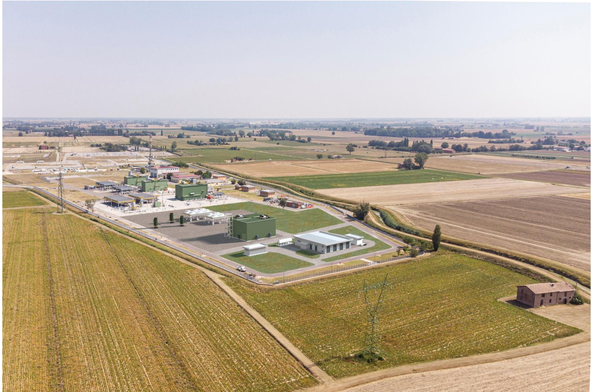
Panoramica dall'alto ripresa dal Drone. Nell'immagine sono stati modellati e fotoinserti solo i seguenti elementi: Nuova unità di compressione elettrica ELC EC8; Nuovo fabbricato sottostazione ELCO; Nuovo fabbricato HVAC per sottostazione ELCO; Nuovo fabbricato cabina elettrica MT (media tensione); Nuovi refrigeranti gas; Nuovo filtro gas principale e filtri separatori.
