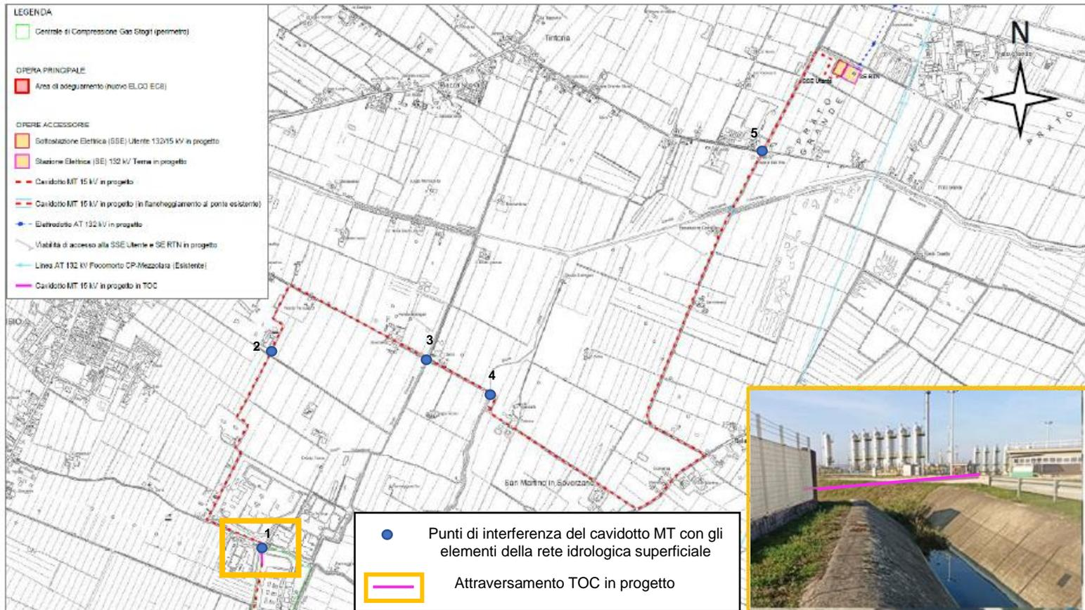
Figura 3.5.1: Tracciato cavidotto MT base CTR e interferenze con i principali elementi della rete idrologica superficiale. Nel riquadro giallo, il tratto trenchless (attraversamento1) è riportato con linea color magenta
