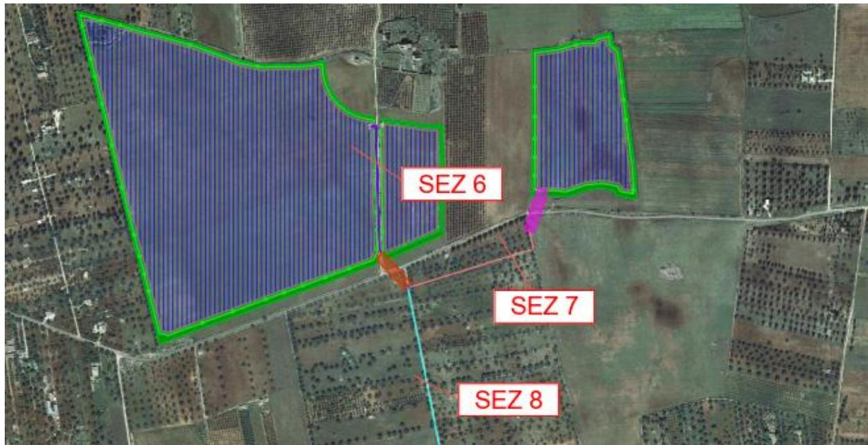
Figura 5-2 – Sezioni per definizione campo magnetico, cavi MT – Percorso esterno
