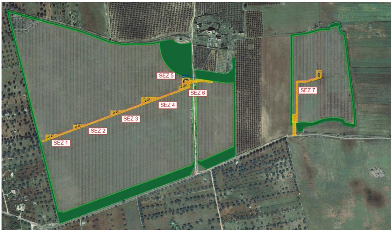
Figura 5-1 – Sezioni per definizione campo magnetico, cavi MT – Percorso interno
