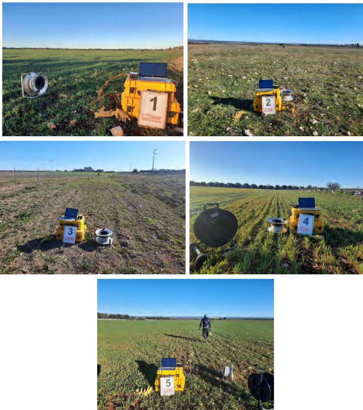
Figura 7-7 – Vista ubicazione basi simiche a rifrazione
