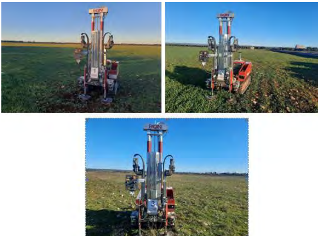
Figura 7-3 – Fasi di esecuzione prove penetrometriche DPHS
