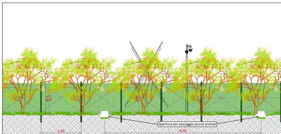
Fig. 7 -17 particolare che mostra le aperture per il passaggio della fauna in corrispondenza della recinzione perimetrale
