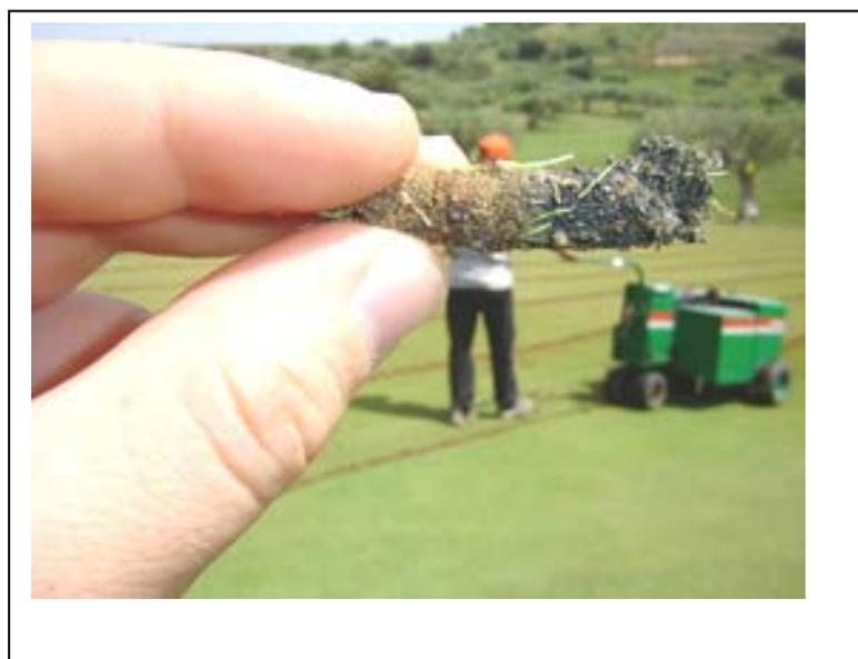
*Figura 7-12 – Esempio di “Black layer” per suoli compattati, naturalmente*
