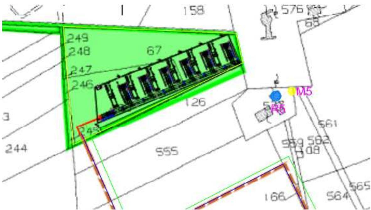
**SOTTOSTAZIONE:** Indicazione dei ricettori (pallini azzurri), dei punti di misurazione di Leq(A) (pallini gialli), in verde l'area della sottostazione
