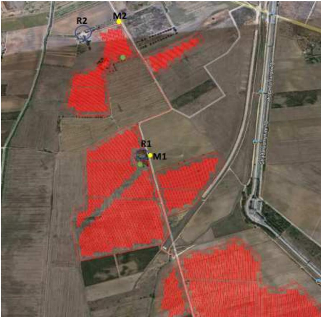
Indicazione dei ricettori (pallini azzurri), delle cabine di trasformazione BT/MT più vicine (pallini verdi), dei punti di misurazione di Leq(A) (pallini gialli)
