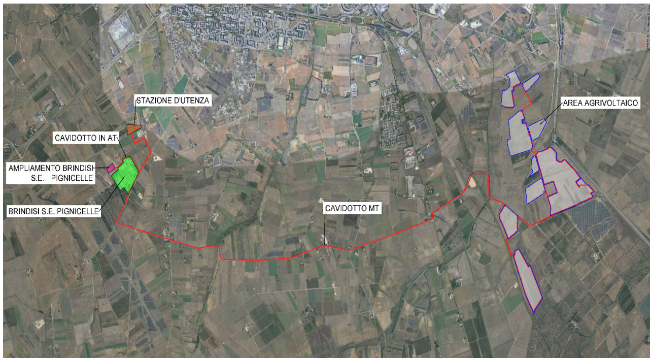
Tavola n. 2: connessione impianto con "Stallo" e stazione di restituzione di "Pignicelle".
