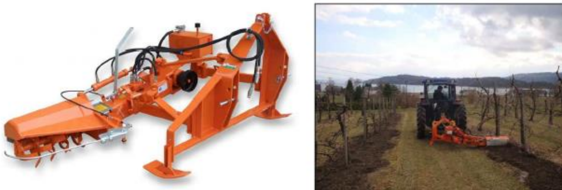
Figura 10: Esempio di fresatrice interceppo per le lavorazioni sulla fila
