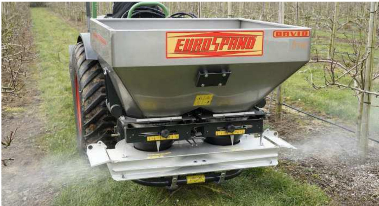
Figura 24: Esempio di spandiconcime localizzato mono/bilaterale per frutteti
