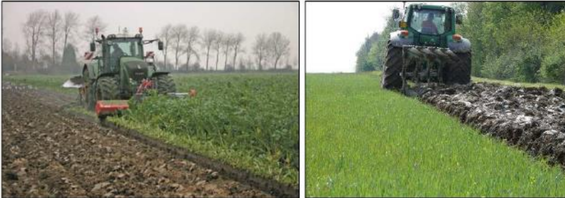
Figura 12: Esempio di pratica del sovescio in pieno campo. Si noti, nell'immagine a sinistra, l'impiego di una trincia frontale montata sulla stessa trattoria per alleggerire il carico sull'aratro portato
