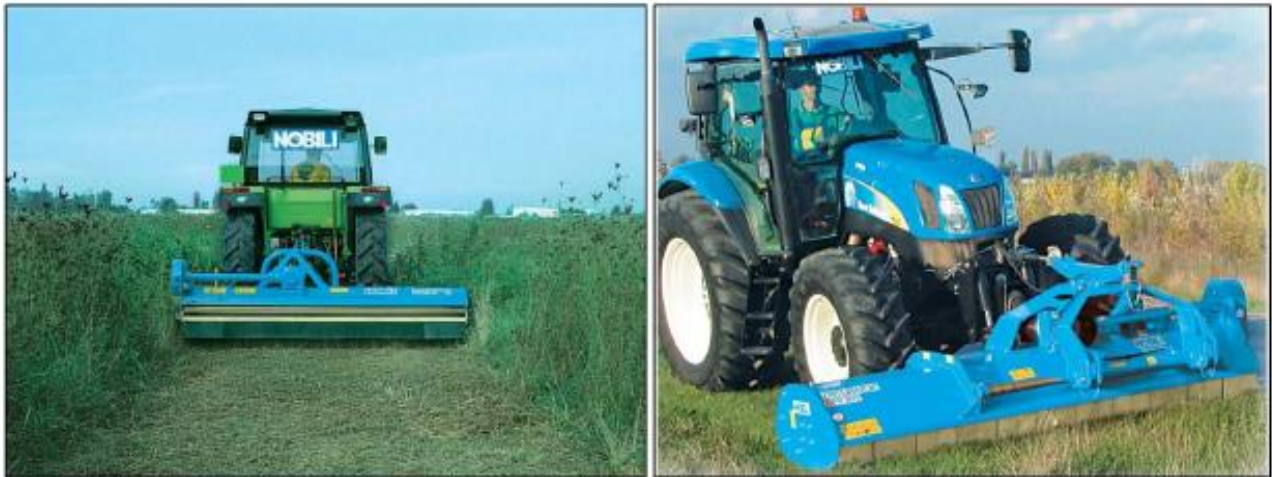
Figura13: Esempi di trincia posteriore e anteriore di notevole larghezza
