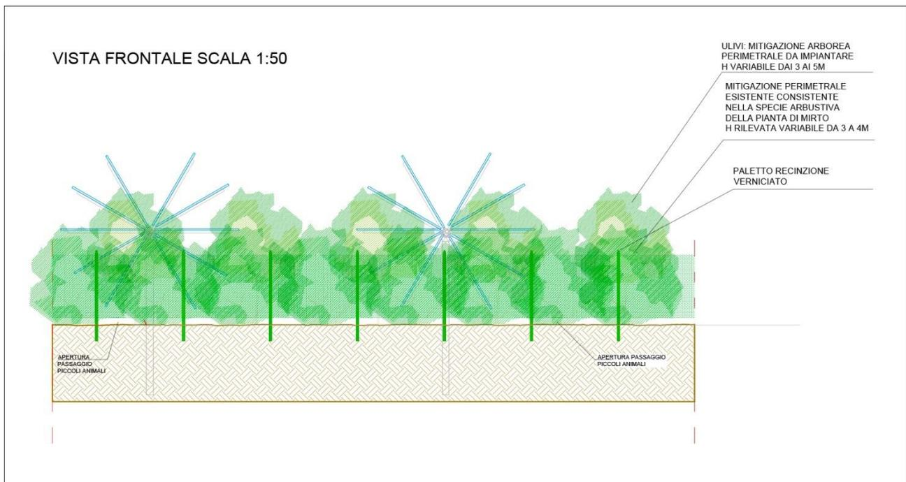
**Figura 10: Vista frontale recizione con Mitigazione**
