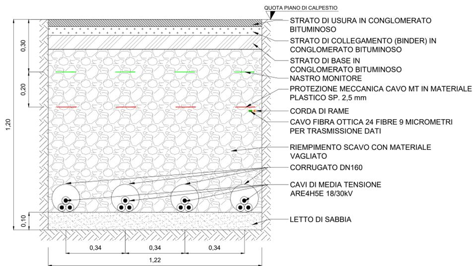
CAVIDOTTO TIPO MT SU STRADA STERRATA/ASFALTATA - Scala 1:10
