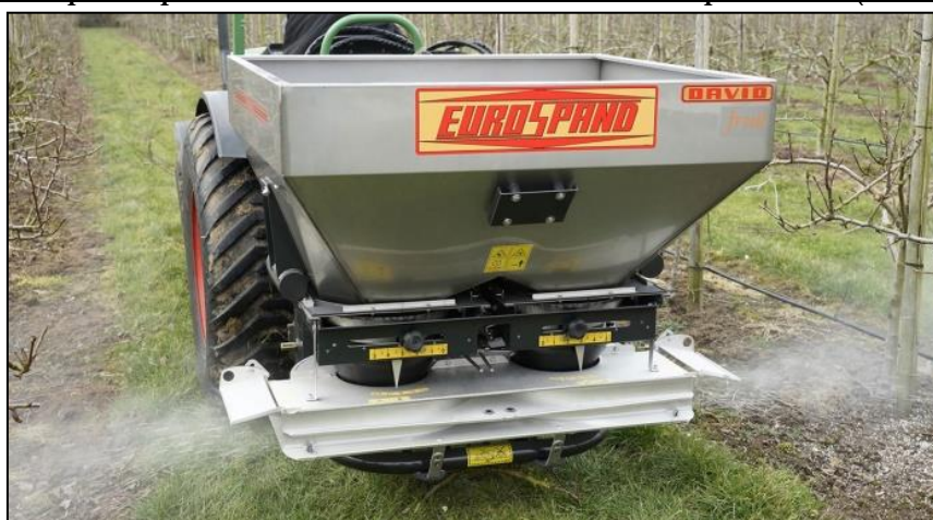
Figura 7.3: esempio di spandiconcime localizzato mono/bilaterale per frutteti (Foto: EuroSpand)
