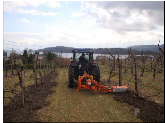
Figura 5.3: Esempio di fresatrice interceppo per le lavorazioni sulla fila (Foto: Rinieri S.r.l.)
