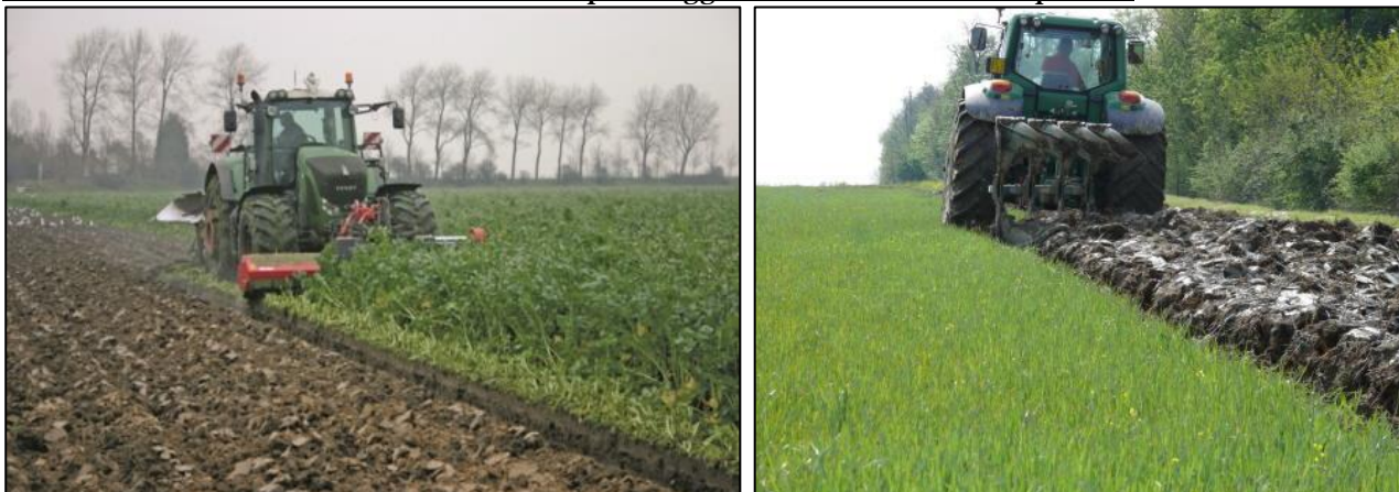
Fig. 6.2: Esempio di pratica del sovescio in pieno campo. Si noti, nell'immagine a sinistra, l'impiego di una trincia frontale montata sulla stessa trattrice per alleggerire il carico sull'aratro portato
