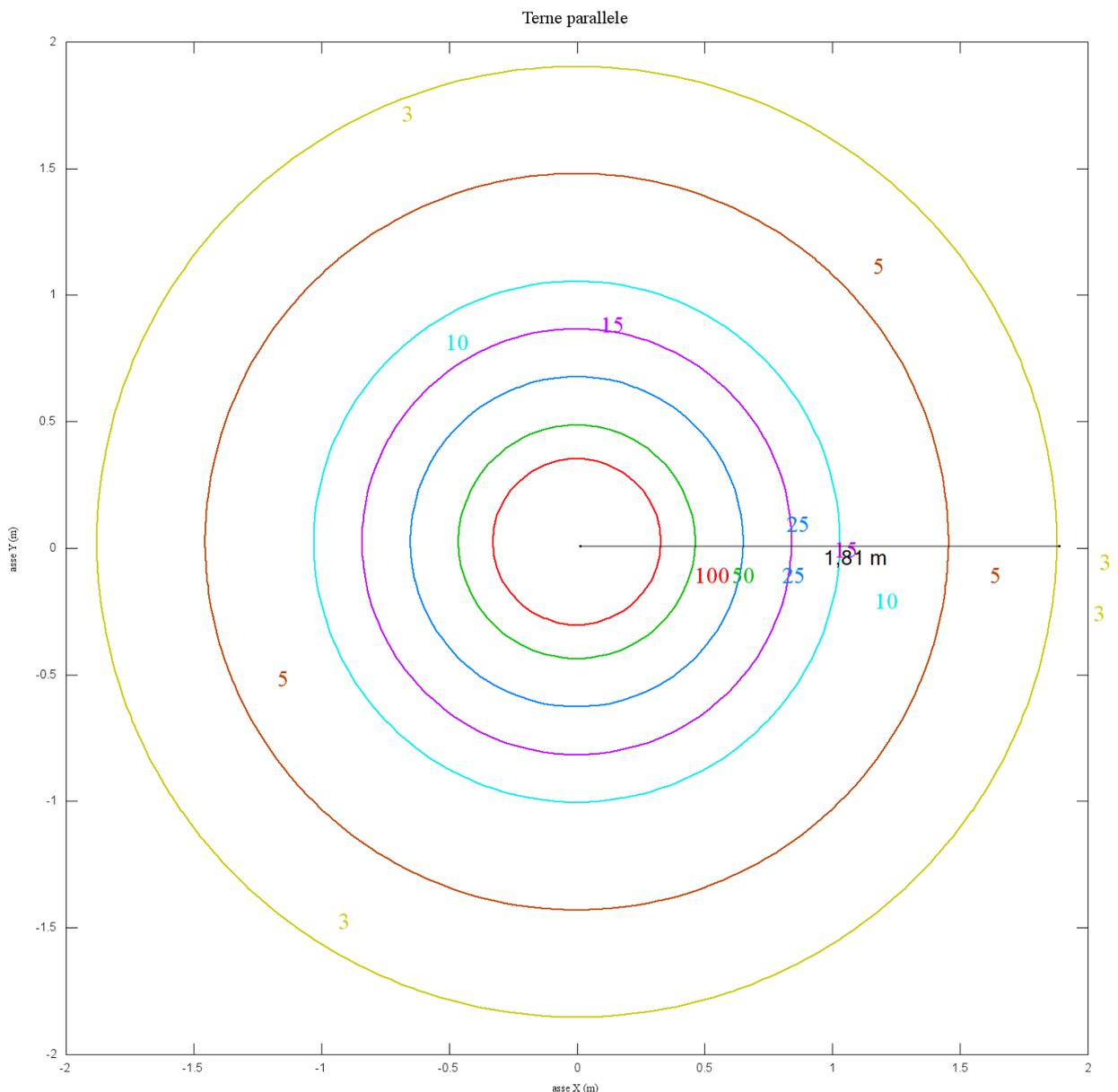
**Figura 3. Curve isolivello andamento induzione magnetica B**
