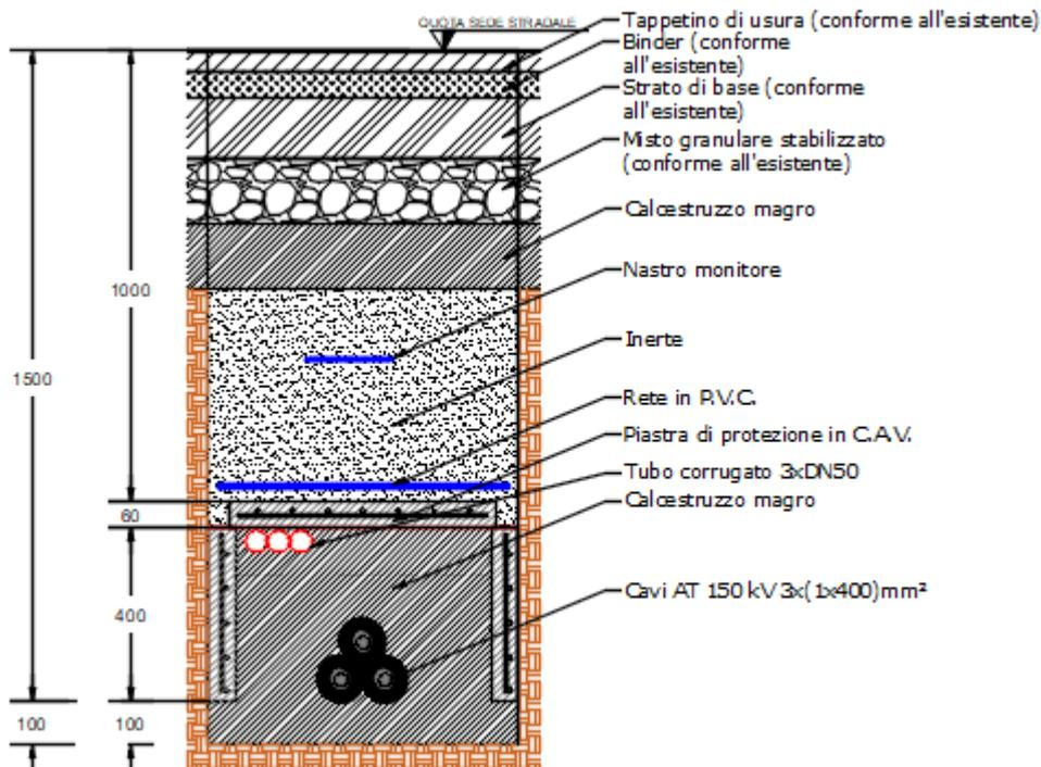
**Figura 2. Sezione tipo cavidotto AT su strada asfaltata**
