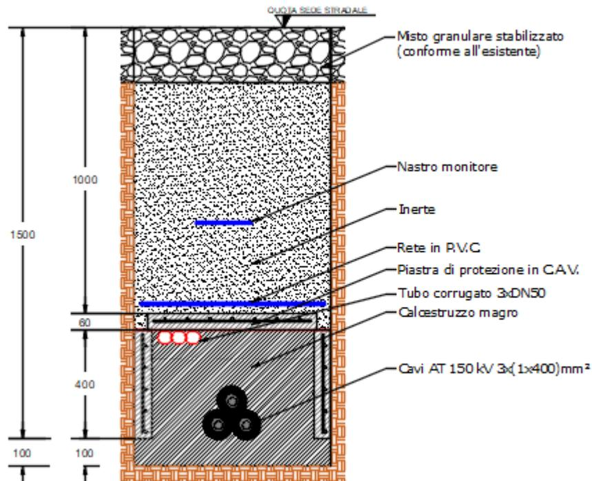
Figura 1. Sezione tipo cavidotto AT su strada sterrata
