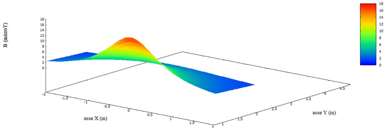
**Figura 4. Andamento 3D induzione elettromagnetica per una terna a 1,5 m di profondità**
