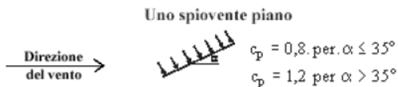
Figura 4 - Definizione dei coefficienti di pressione
