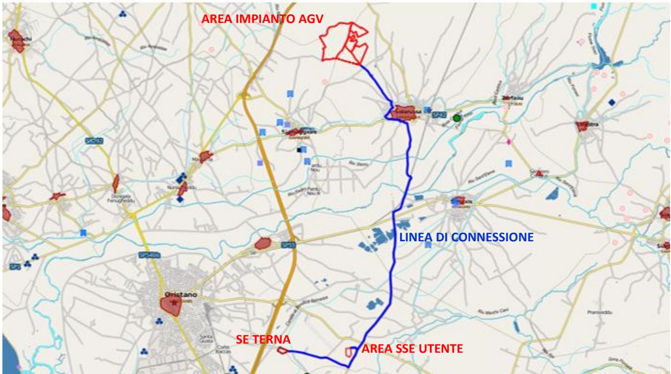
Figura 3: Stralcio mappa stradale della zona di intervento con indicazione del campo AGV, della linea di connessione e della SSE utente (fonte sardegna geoportale).
