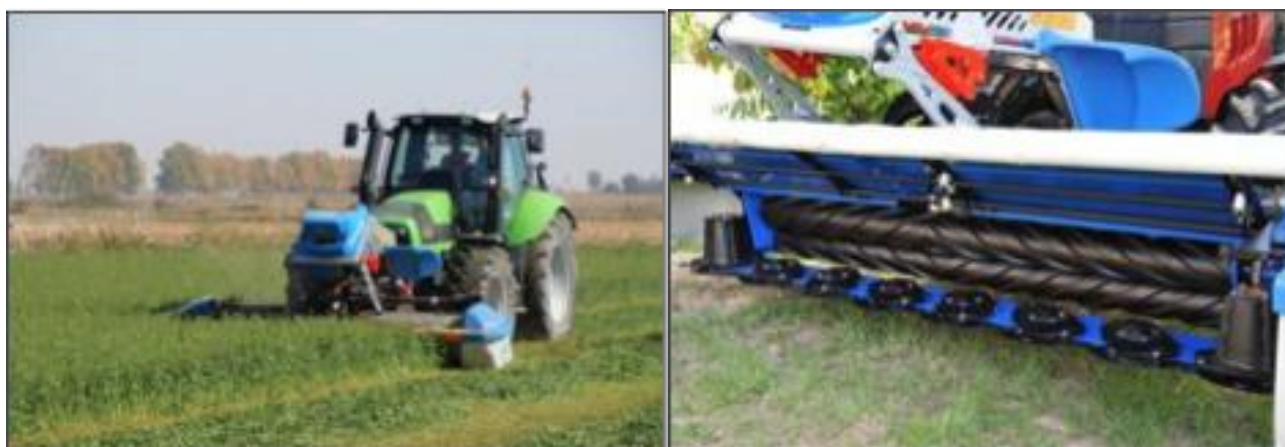
Figura 15: Esempio di falciacondizionatrice frontale e particolare dei rulli in gomma.
