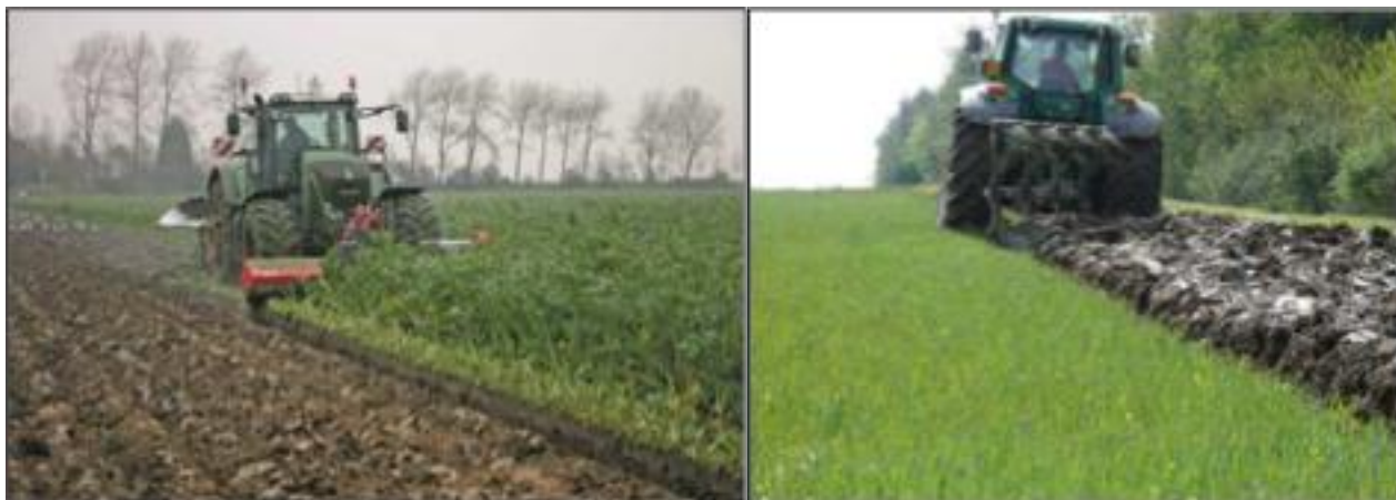
Figura 12: Esempio di pratica del sovescio in pieno campo. Si noti, a sinistra, l’impiego di una trincia frontale montata sulla stessa trattoria per alleggerire il carico sull’aratro portato.
