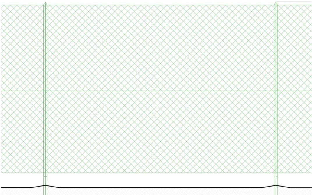
Figura 35: Particolare recinzione perimetrale con apertura inferiore (20-30 cm).
