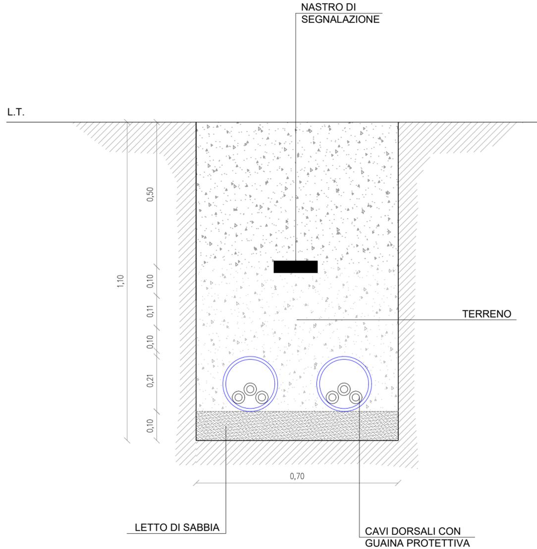
Particolare scavo tipo per posa cavidotto MT
