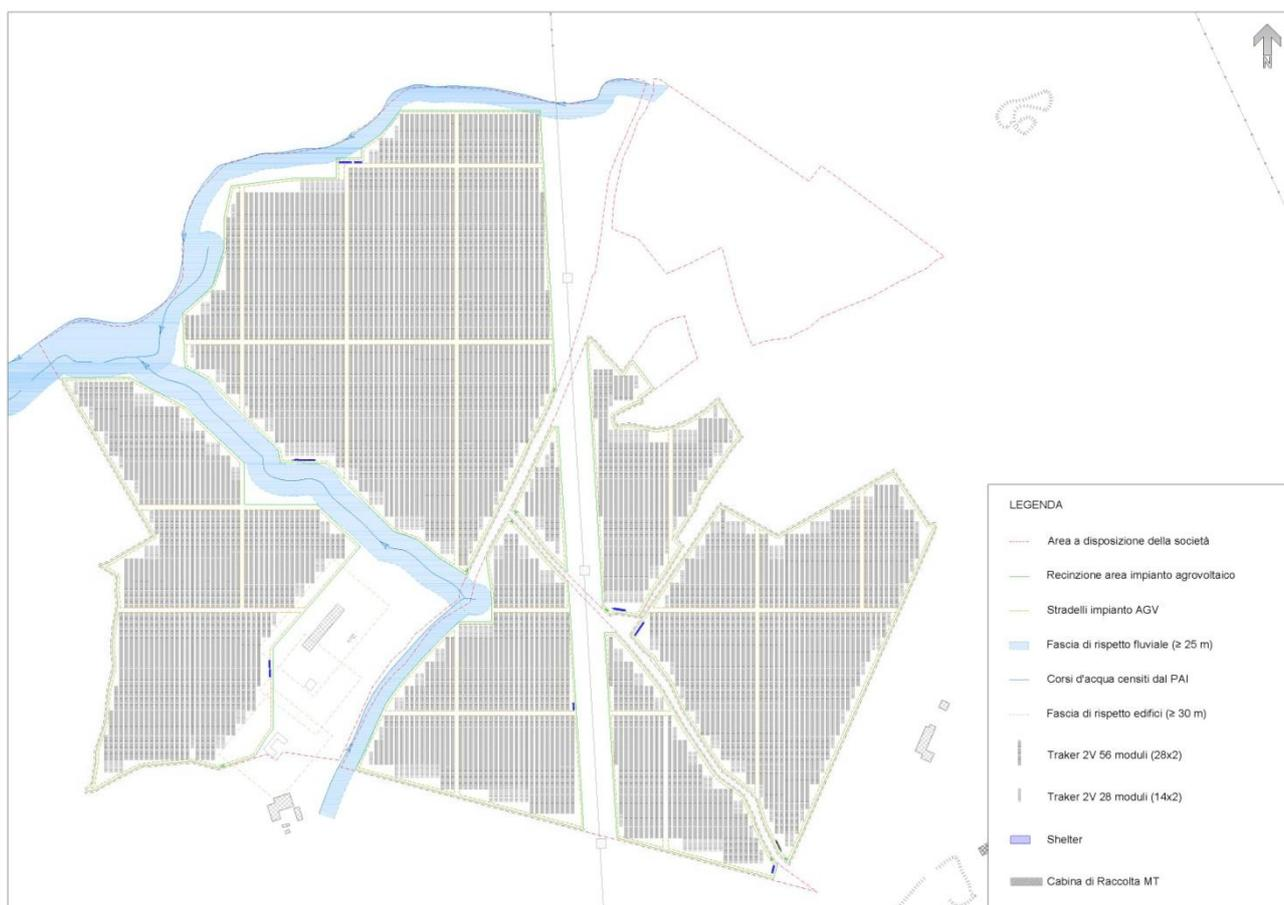
Figura 68: Planimetria layout impianto con indicazione delle fasce di rispetto fluviali.
