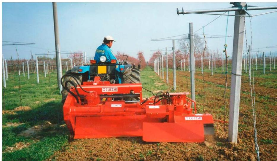
Figura 48: Esempio di fresatrice interceppo per le lavorazioni sulla fila (fonte Cucchi Macchine Agricole).
