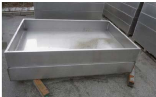
Figura 4.3: Vasca di raccolta olio
