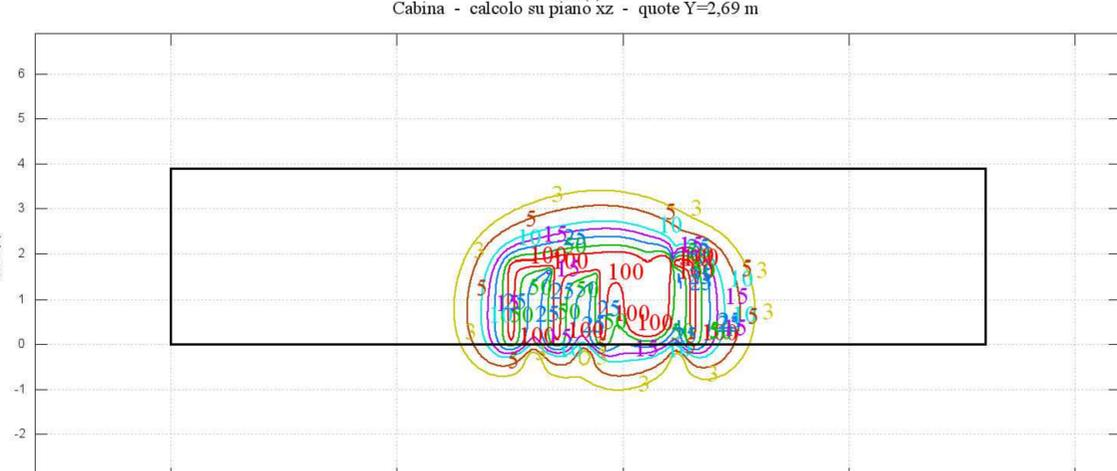
ISOLINEE INDUZIONE MAGNETICA B EMessa DALLA CABINA AT/BT DI RACCOLTA. OBIETTIVO DI QUALITÀ DI 3 AT RAGGIUNTO A DISTANZA < DI 0,19 METRI DAL PERIMETRO OCCUPATO DAGLI IMPIANTI. LA DISTANZA DI PRIMA APPROSSIMAZIONE (DPA) SI ASSUME PARI A 0,5 m.
