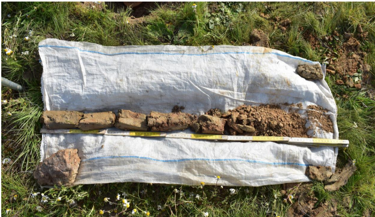
Figura 4 – Trivellata eseguita nella stazione per caratterizzare gli orizzonti più profondi
