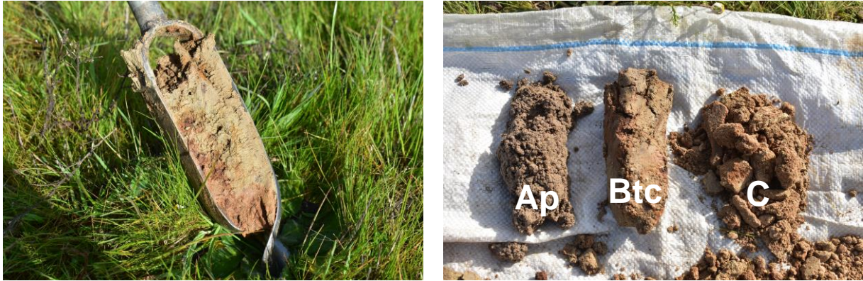
Figura 5 – A sinistra campione di una trivellata dell'orizzonte Btc, sono apprezzabili le screziature rossastre che si distinguono dai colori più chiari della matrice. A destra confronto tra campioni dei tre orizzonti rilevati.
