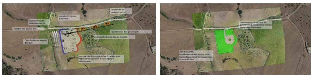
Fig. 39 – Ingombri di cantiere e aree di ripristino per fase di esercizio piazzola WTG N09
