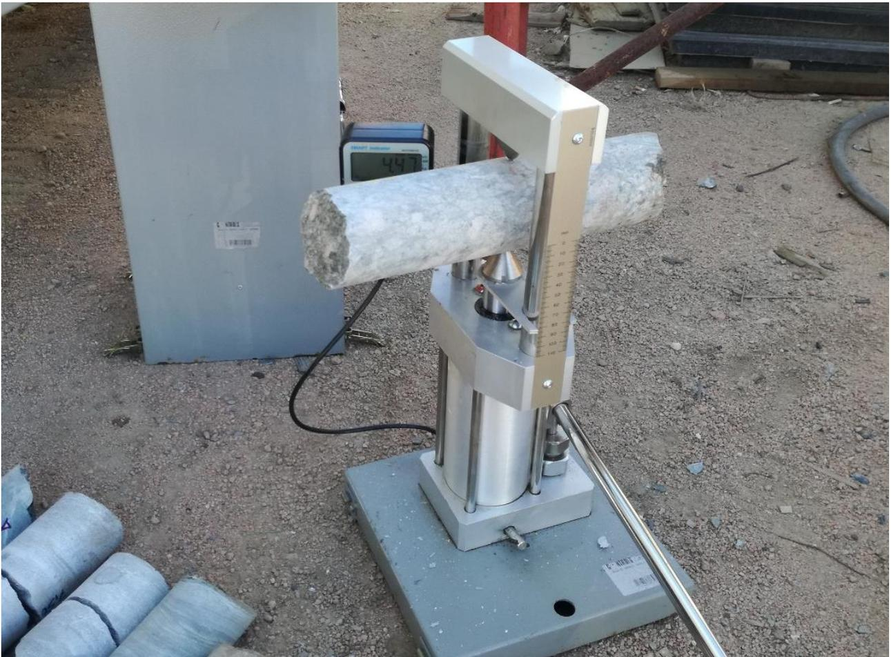
Figura 23 - Esecuzione delle prova Point Load
