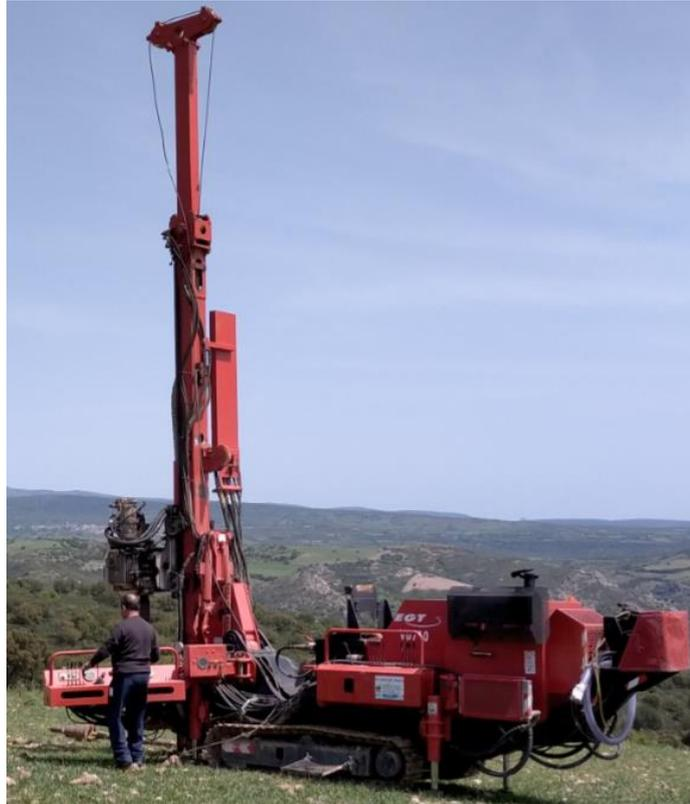
Figura 16 - Sonda EGT VD710
