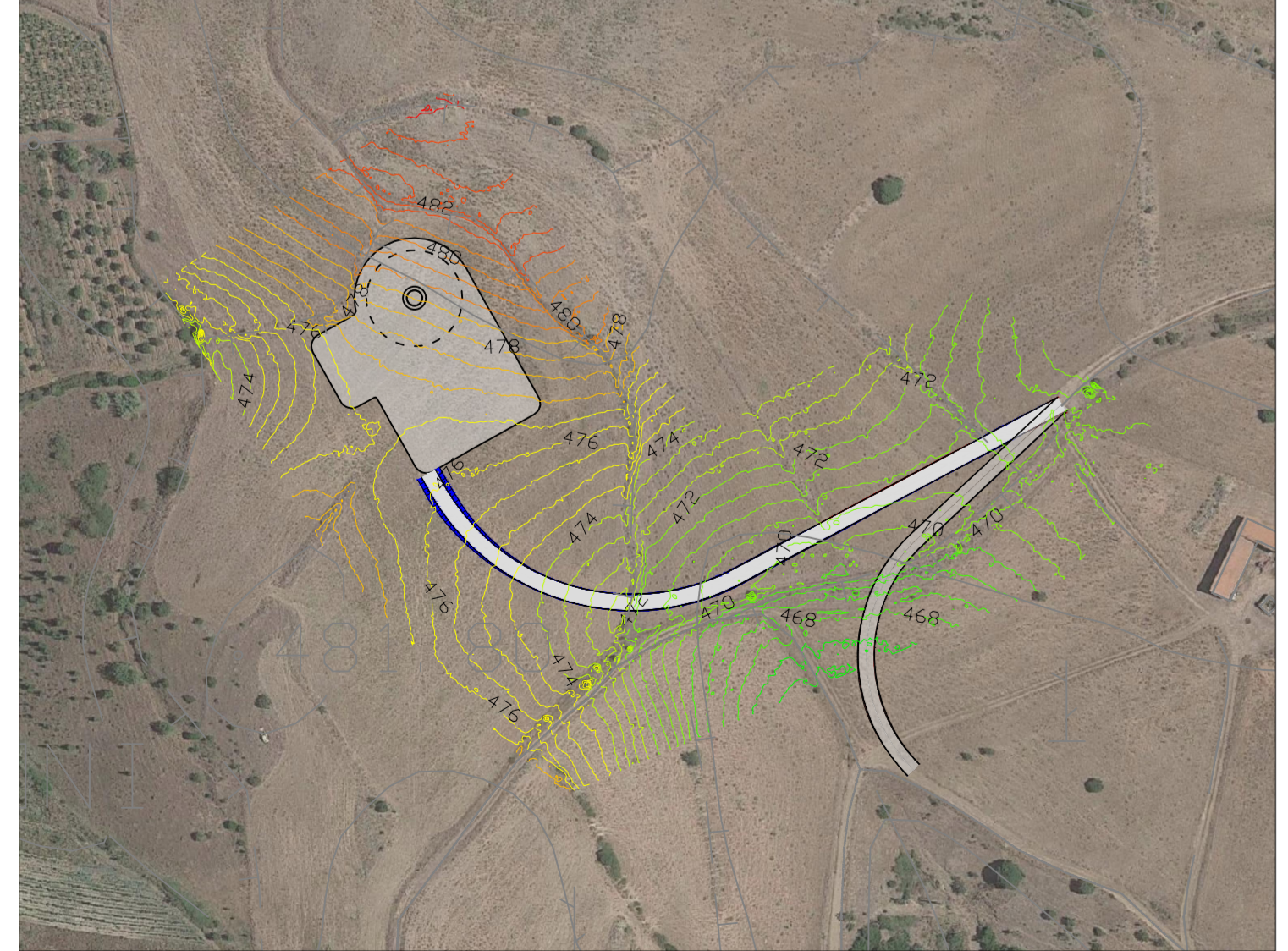
PLANIMETRIA NUOVA VIABILITA' DI ACCESSO ALLA PIAZZOLA N08 E N09 SU CURVE DI LIVELLO DA RILIEVO SAPR E SU CTR SCALA 1:2.000
