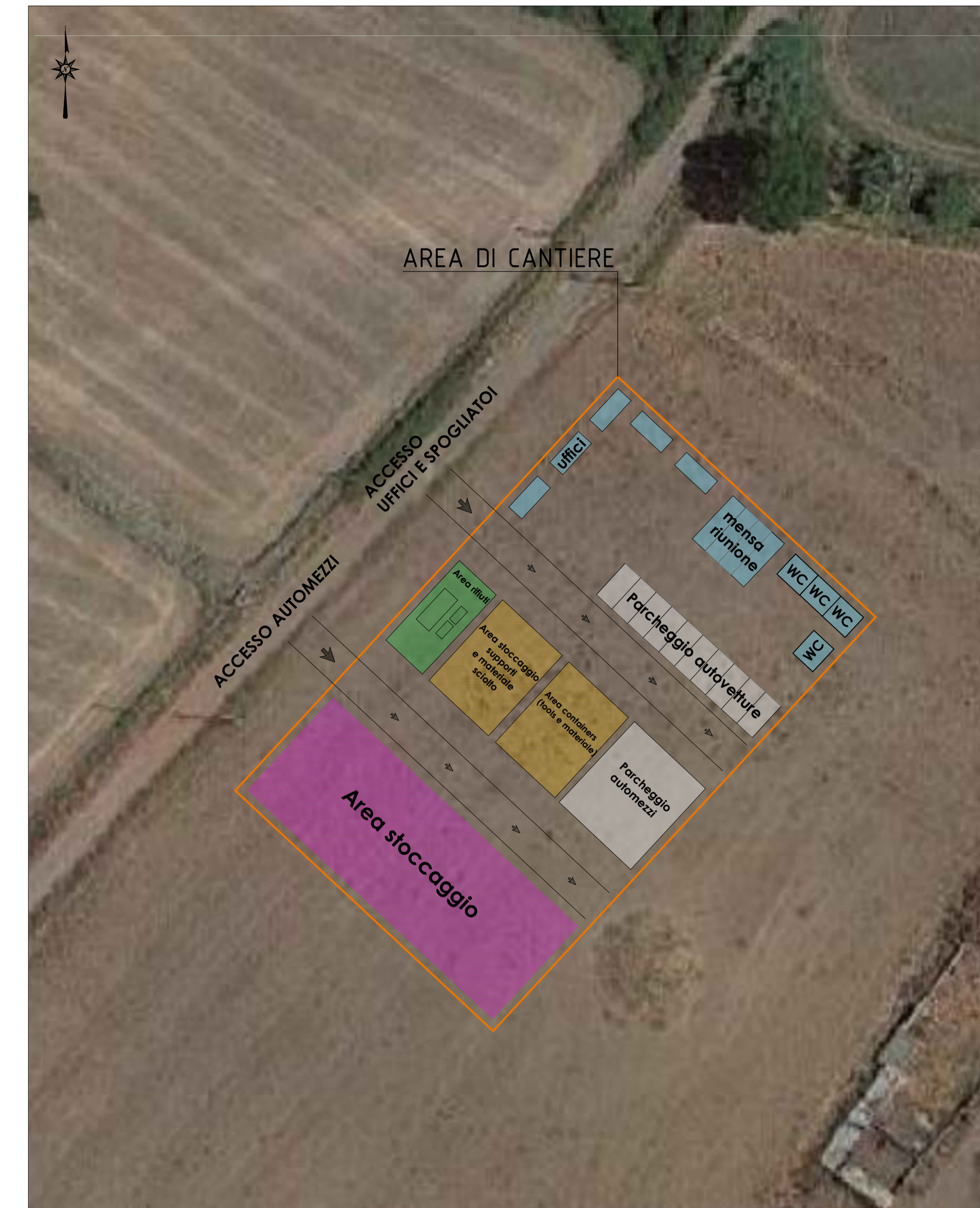
DISTRIBUZIONE PLANIMETRICA TIPOLOGICA AREA DI CANTIERE SCALA 1:500
