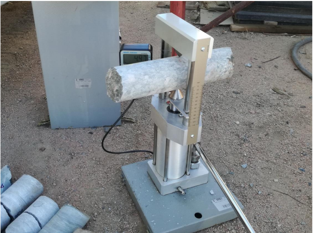
Figura 23 - Esecuzione delle prova Point Load
