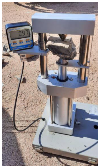
FOTO 1 – Esecuzione delle prove Point load
