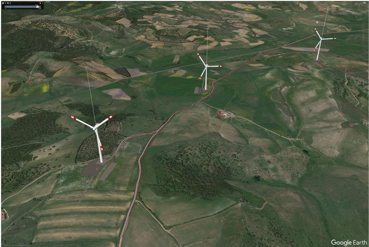
Le piazzole temporanee sono duplicate e rappresentate del colore del terreno in fase di cantiere e di colore verde in fase di esercizio, in quanto ripristinate e rinaturalizzate.
