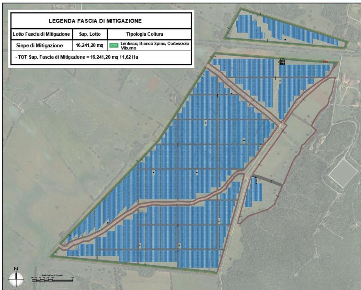
Figura 30: Immagine con indicazione del posizionamento della siepe di mitigazione sui confini.
