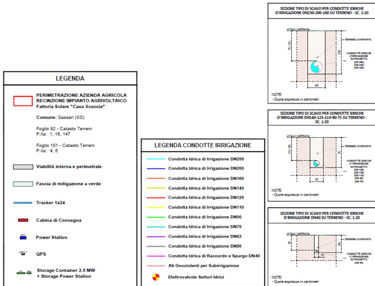
Figura 31: Layout Impianto di Irrigazione/Fertirrigazione con legende e Sezioni tipo di scavo per le condotte. Riferimento Elaborato Grafico "2202\_T.P.09\_Layout Impianto di Irrigazione/Fertirrigazione\_Rev00"
