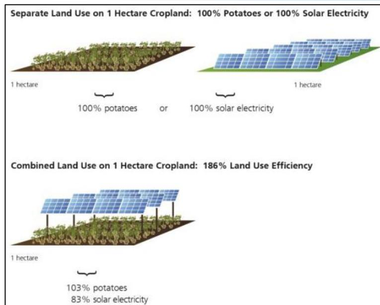
Figura 33: Rappresentazione delle varie tipologie di utilizzo del suolo, agricolo, con moduli fotovoltaici a terra e combinato, così da abbattere il consumo di suolo per l'uno o per l'altro utilizzo. Dal progetto “Agrophotovoltaics Resource Efficient Land Use (APV-RESOLA)” condotto dall'ISE e dell'Università di Hohenheim tra il 2017 e il 2019.
