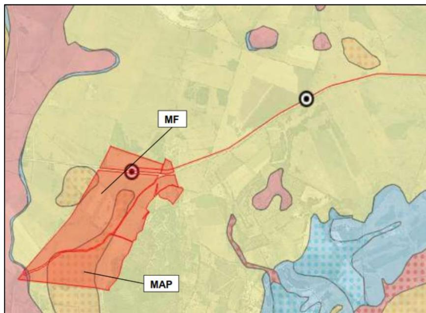
Figura 10: Carta di permeabilità dei substrati della Sardegna, scala 1:25.000, da Relazione Geologica allegata “2202\_R.06\_Relazione Geologica Preliminare\_Rev00”, in cui risulta una situazione caratterizzata da un corpo centrale del lotto con permeabilità alta per porosità (MAP) e permeabilità media per fratturazione (MF).
