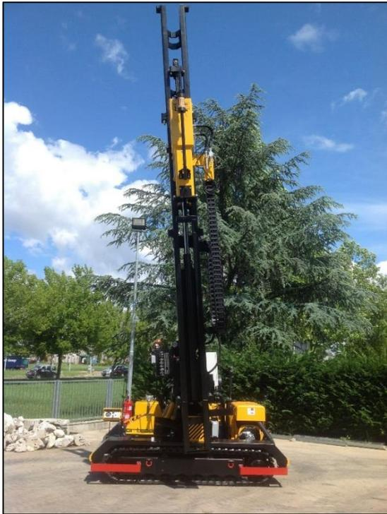
Figura 15: Macchina battipalo per l'infissione dei pali per i tracker.
