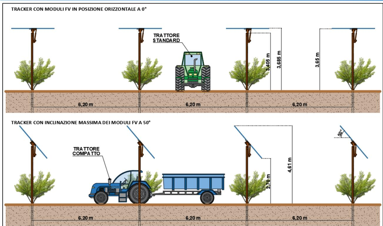
Figura 20: Particolare del campo agrivoltaico in cui si mostra il passaggio dei mezzi agricoli per la manutenzione del mandorlo. Grazie alle strutture ed alla forma di allevamento, lo spazio in verticale ed orizzontale utilizzabile al di sotto è sufficiente soprattutto affinché le piante beneficino della luce diretta e di quella diffusa.
