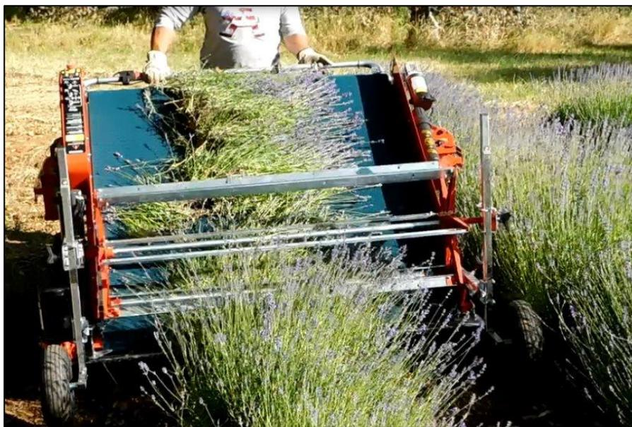
Figura 28: Macchinario per la raccolta delle piante aromatiche. In figura è mostrata la raccolta della lavanda tramite taglio e carico, ma la stessa operazione viene effettuata con le piante di rosmarino.
