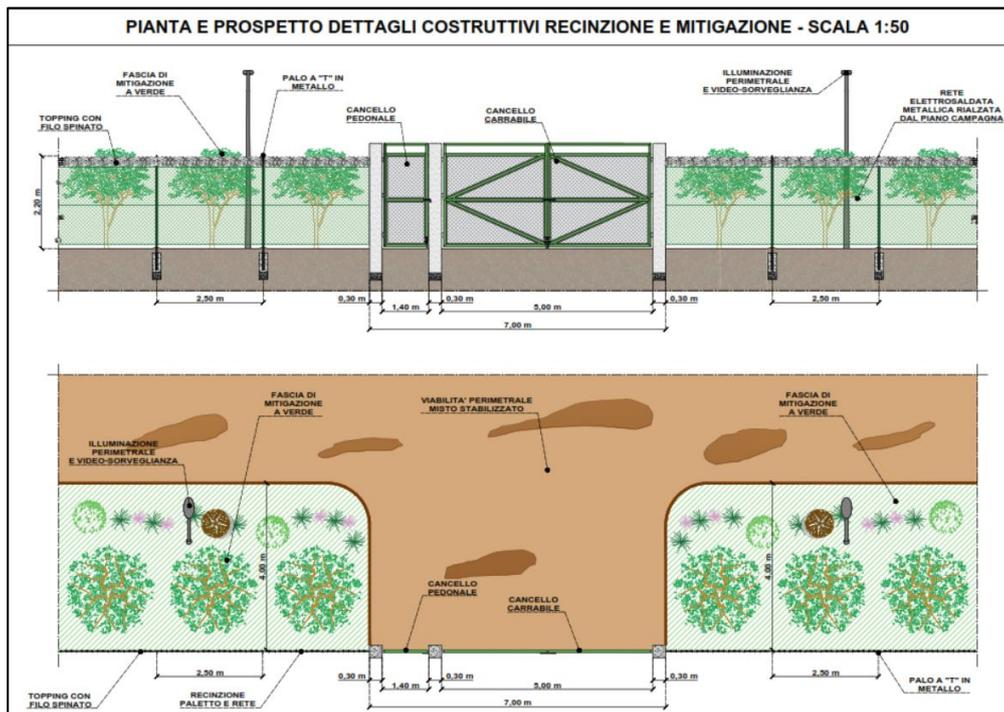
Figura 29: Immagine della recinzione dell'area, composta da una componente metallica e da una siepe di mitigazione. Si fa riferimento al documento allegato "2202\_T.P.05\_Layout Impianto e Dettagli Recinzione e Mitigazione\_Rev00".
