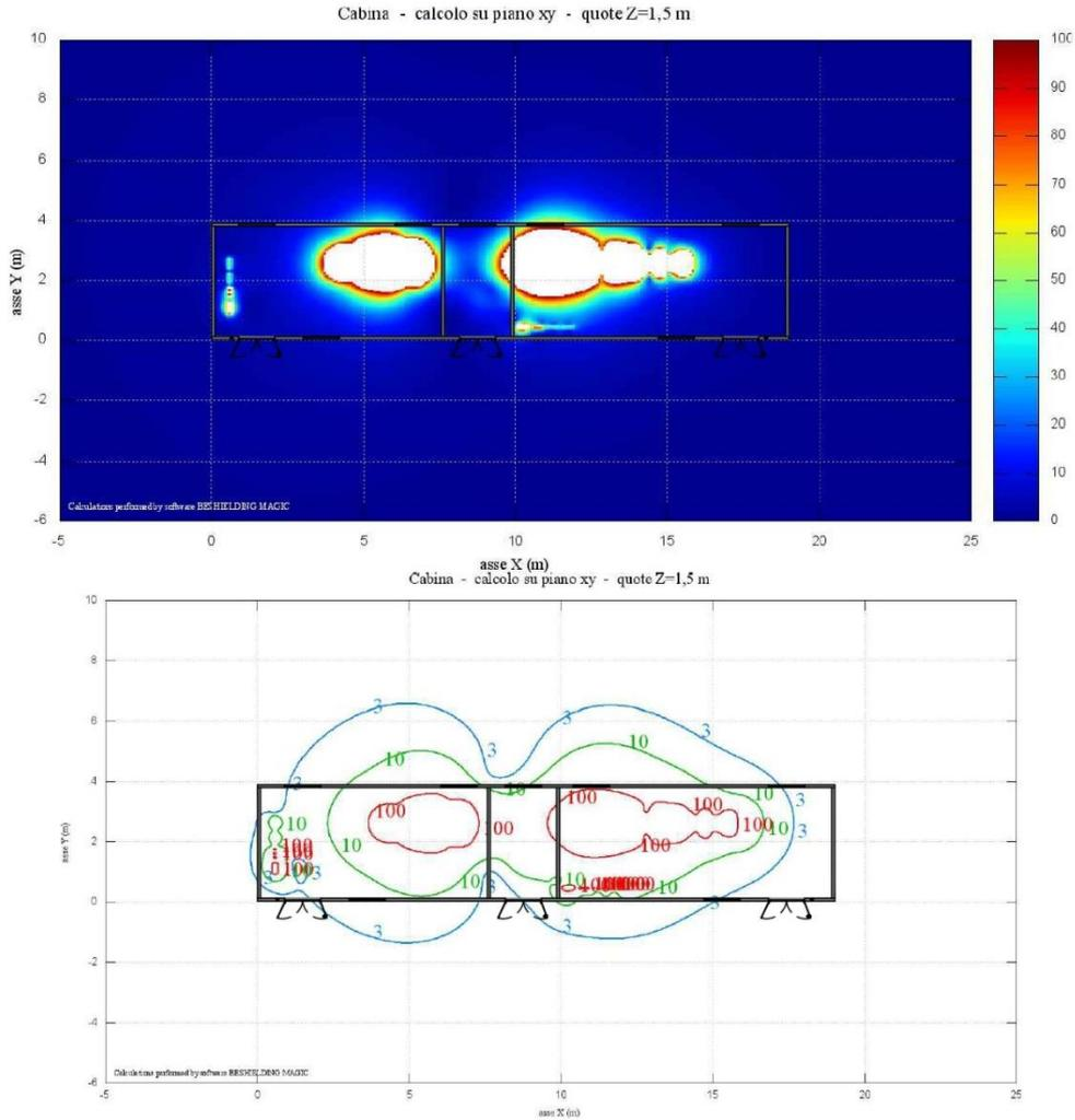
Figura 25: Cabina di Raccolta, h = 1,5 m, mappa 2D e curve isolivello
