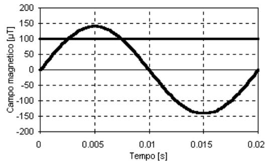
*Figura 2: Campo magnetico corrente alternata*
