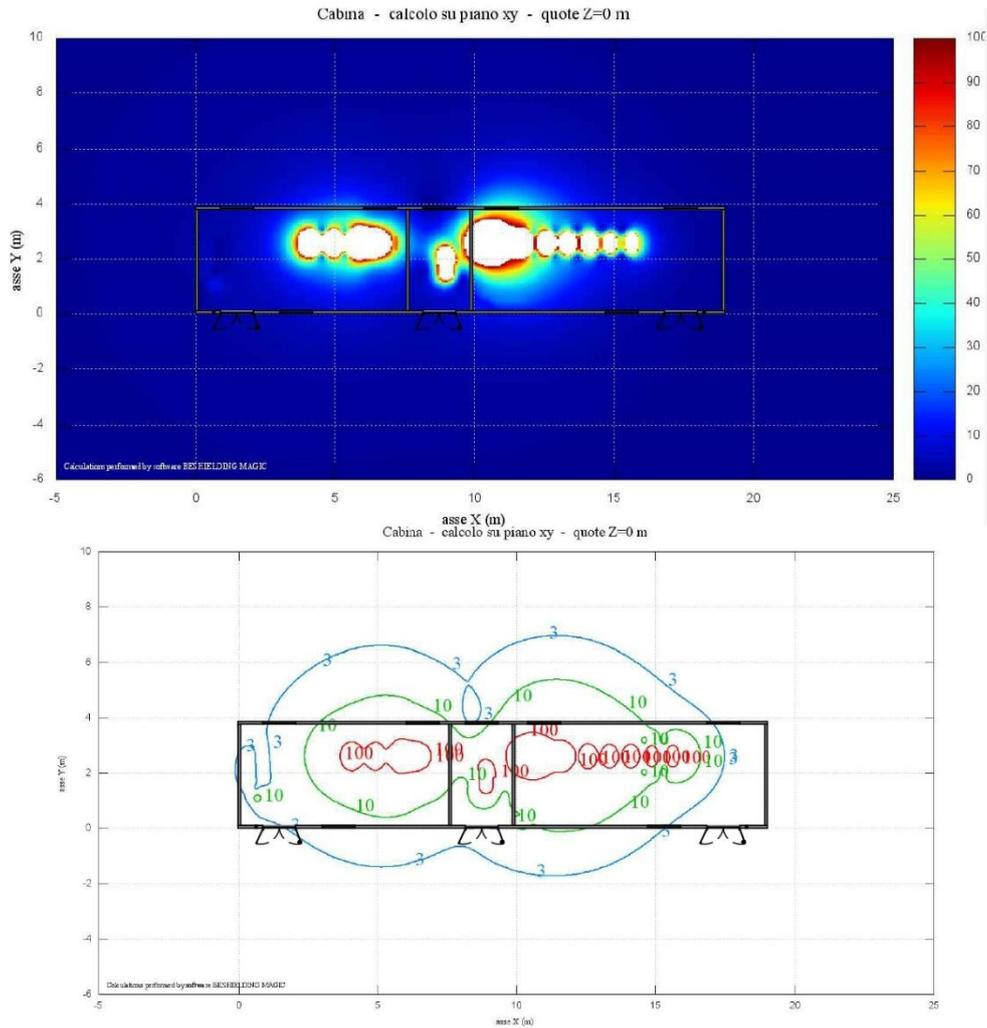
Figura 24: Cabina di Raccolta,  $h = 0$  m, mappa 2D e curve isolivello
