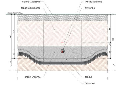
VISTA SEZIONE DI SCAVO AT AC
