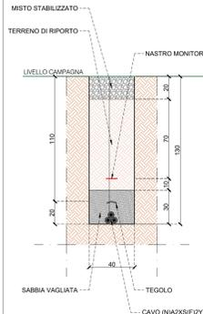
SEZIONE DI SCAVO AC 2A
