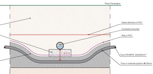
SEZIONE DI SCAVO - PARTICOLARE INTERSEZIONE TRA CONDOTTA CONSORTILE E CAVIDOTTO/CONDOTTA DI IRRIGAZIONE NEL PUNTO "C" (SCALA 1:20)
