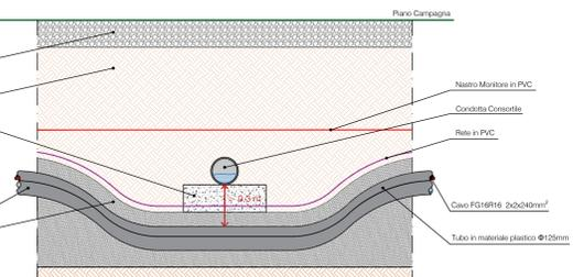
SEZIONE DI SCAVO - PARTICOLARE INTERSEZIONE TRA CONDOTTA CONSORTILE E CAVIDOTTO NEL PUNTO "D" (SCALA 1:20)
