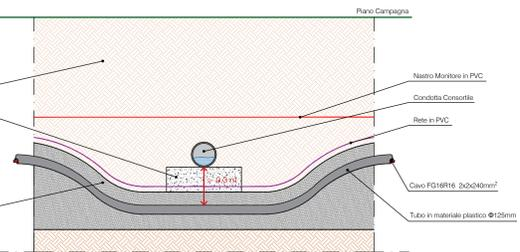
SEZIONE DI SCAVO - PARTICOLARE INTERSEZIONE TRA CONDOTTA CONSORTILE E CAVIDOTTO NEL PUNTO "B" (SCALA 1:20)
