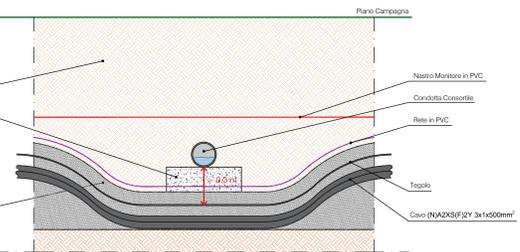
SEZIONE DI SCAVO - PARTICOLARE INTERSEZIONE TRA CONDOTTA CONSORTILE E CONDOTTA DI IRRIGAZIONE NEL PUNTO "E" (SCALA 1:20)
