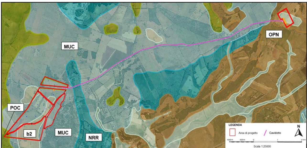
Figura 64: Stralcio della carta geologica dell'area. Legenda: MUC – Formazione di Monte Uccari; NRR – Formazione di Monte Nurra; POC – Formazione di Capo Caccia; OPN – Formazione di Oppia Nuova; b2 – Coltri eluvio-colluviali.
