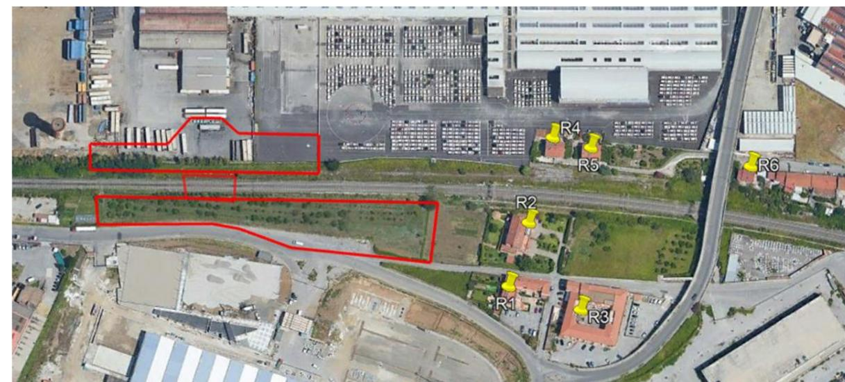
Figura 5-11 Schematizzazione aree di cantiere e relativi ricettori per lo scenario di simulazione
