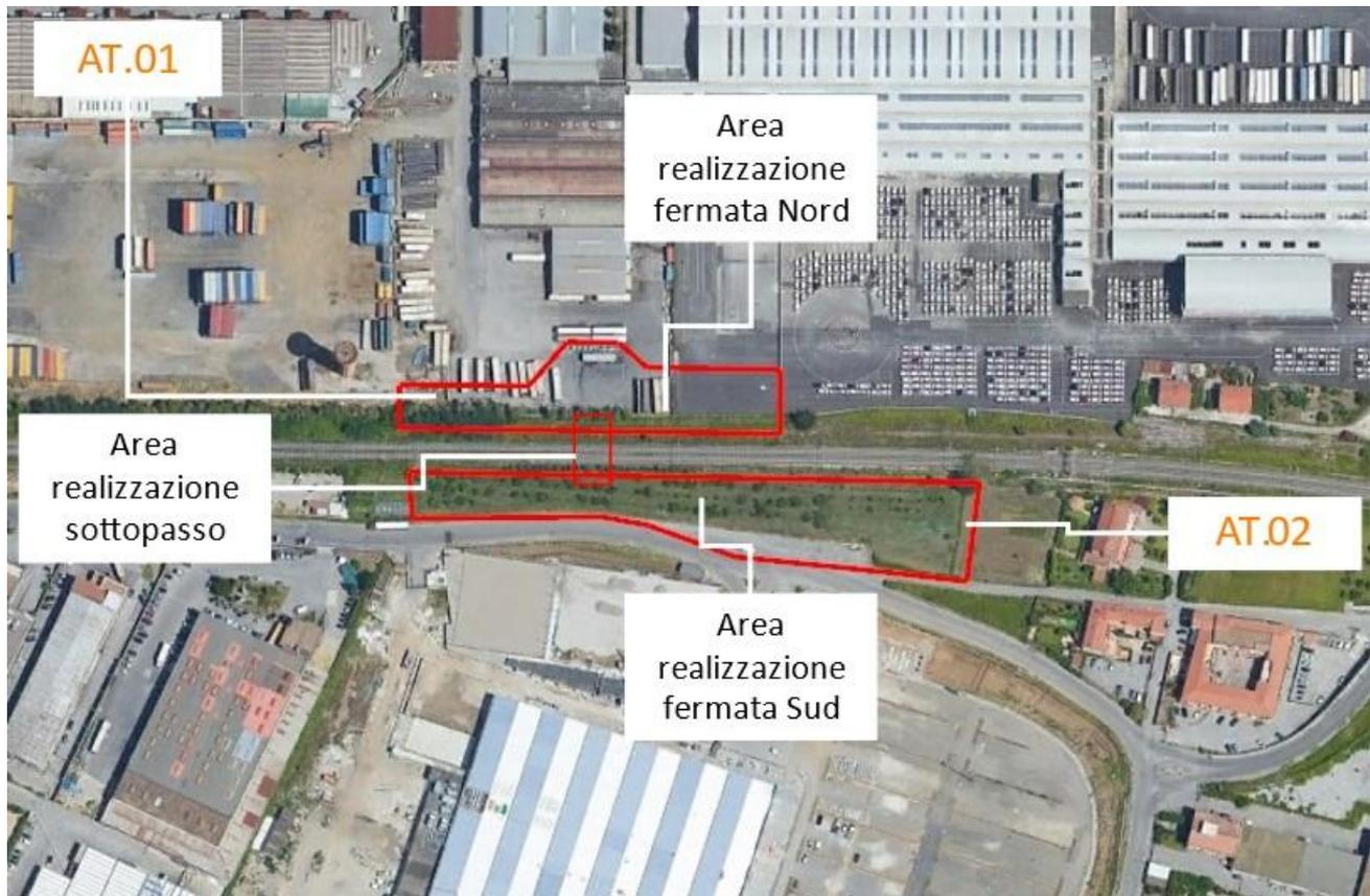
Figura 3-17 Localizzazione delle aree di cantiere e attività di lavorazione relativi allo scenario di simulazione
