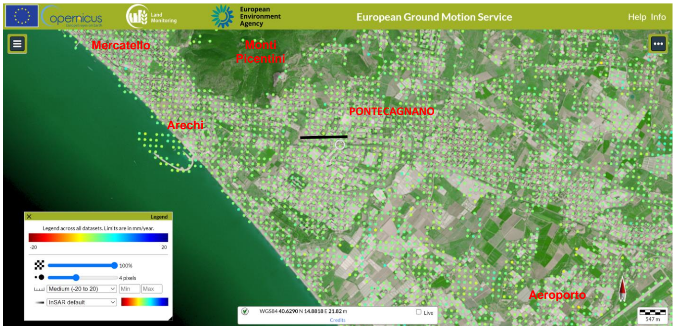
Figura 8-3 – Immagine radar di sentinel-1 basata sull'analisi interferometrica multitemporale, rappresentante le velocità dei punti di misura in coordinate orto asse Ovest- Est nell'area di Pontecagnano. In nero è evidenziata la tratta oggetto di studio.
