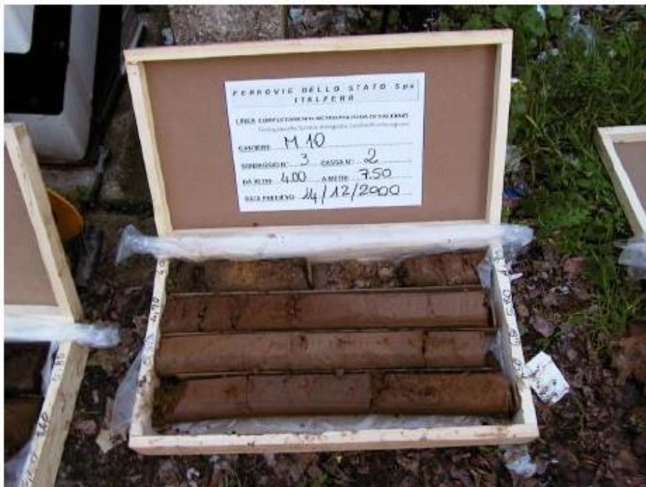
SONDAGGIO 3 – CASSA 2 (DA 4.00 A 7.50 METRI)
