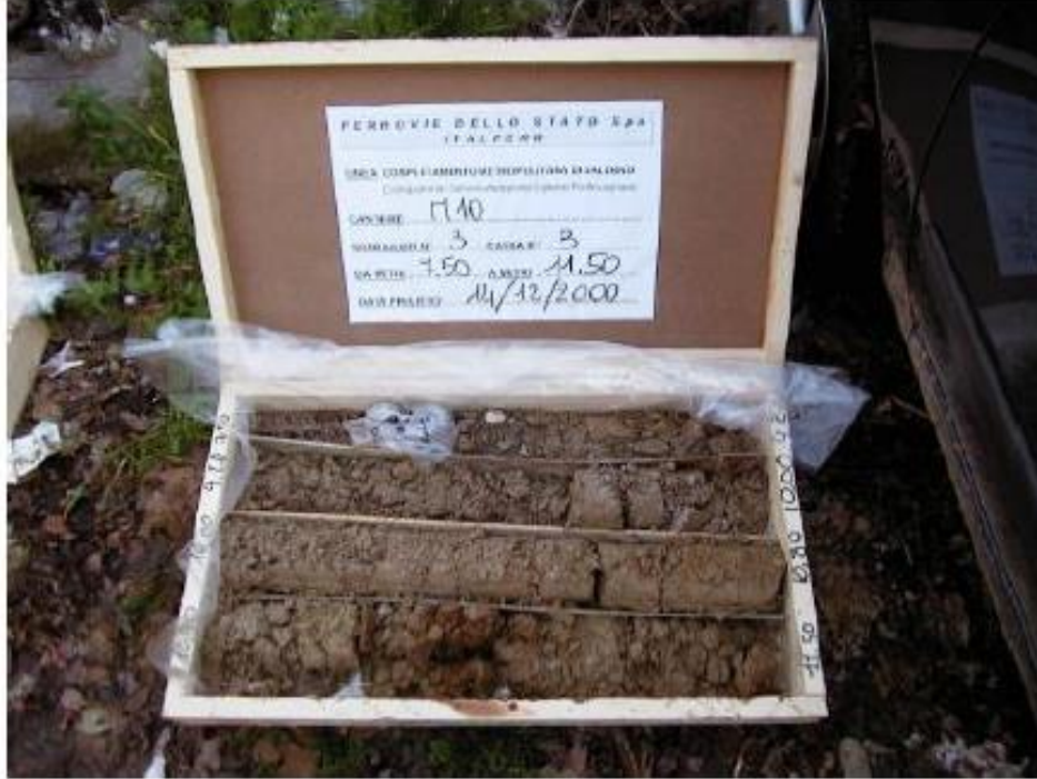
SONDAGGIO 3 – CASSA 3 (DA 7.50 A 11.50 METRI)
