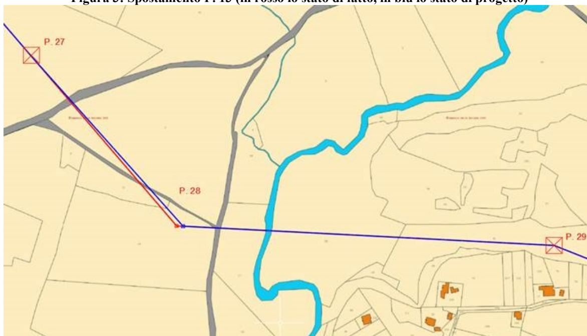
Figura 4: Spostamento P. 28 (in rosso lo stato di fatto, in blu lo stato di progetto)
