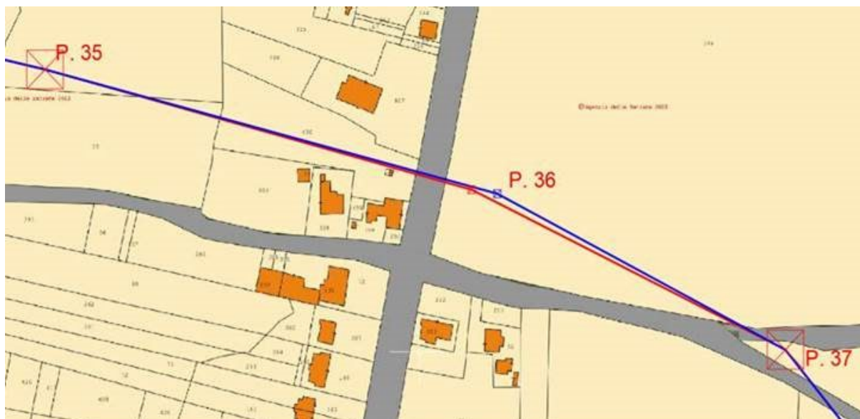
Figura 5: Spostamento P.36 (in rosso lo stato di fatto, in blu lo stato di progetto)
