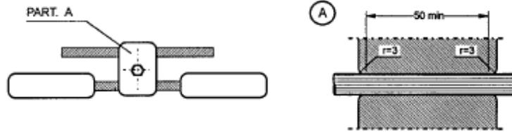
Morsetto ad un solo bullone del tipo "a montaggio facilitato". La lunghezza minima del tratto di conduttore serrato è indicato nel particolare A.
