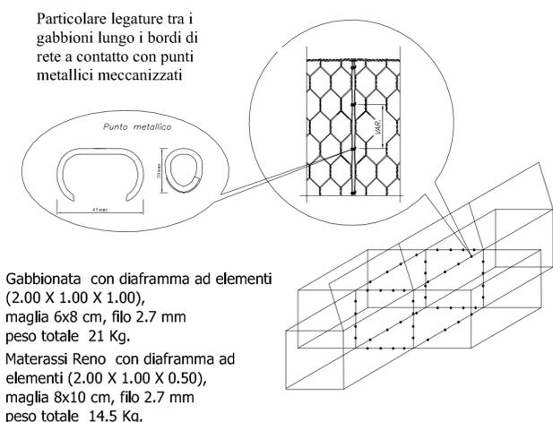
Particolare legature tra i gabbioni lungo i bordi di rete a contatto con punti metallici meccanizzati
