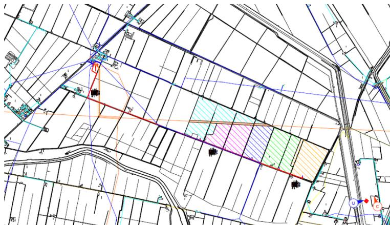
**Figura 7 – Ubicazione cabine di consegna e tracciato cavidotti di connessione alla CP Schiappa secondo planimetrie STMG**
