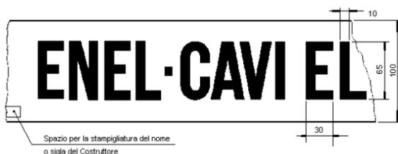
**Figura 12: Nastro monitor per segnalazione presenza cavi elettrici.**
