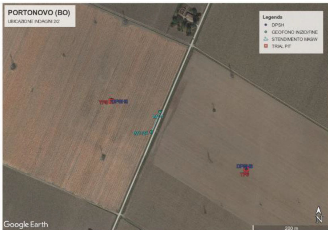
Figura 11 - Dettaglio ubicazione delle indagini geognostiche svolte
