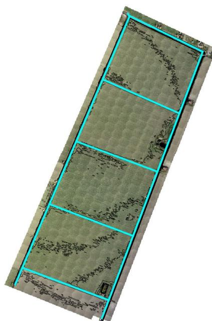
**Figura 17 - Canali di drenaggio (in Ciano) presenti perimetrali e trasversali all'area di impianto su ortofoto con curve di livello a 20 cm.**
