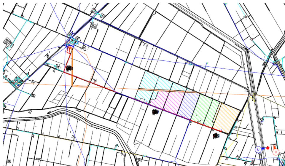
Figura 2 - Ubicazione cabine di consegna e tracciato cavidotti di connessione alla CP Schiappa secondo planimetrie STMG
