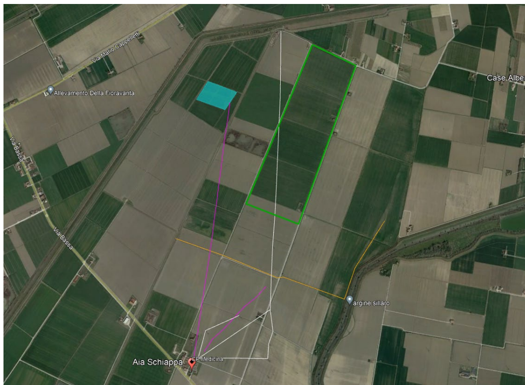
Figura 19 – Aereofoto con ubicazione dell’area di impianto (in verde) ed indicazione elementi detrattori: in arancio il gasdotto, in magenta linee MT, in bianco linea AT, in ciano impianto FV esistente.
