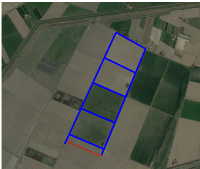
Figura 15: Canali di drenaggio (in blu) presenti perimetrali e trasversali all'area di impianto (in rosso).
