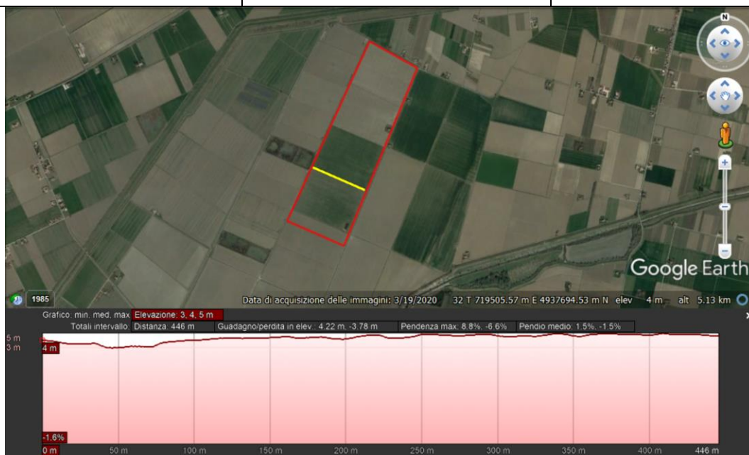
Figura 7: Profilo trasversale da nord-ovest a sud-est della porzione sud dell'area FV ricavato da Google Earth.
